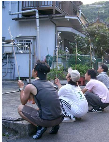
吹き流しを用いた同時多点での風向測定
